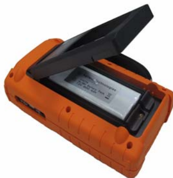
Figura 8-5 Tire a tampa do pacote de baterias sem tirar a base
