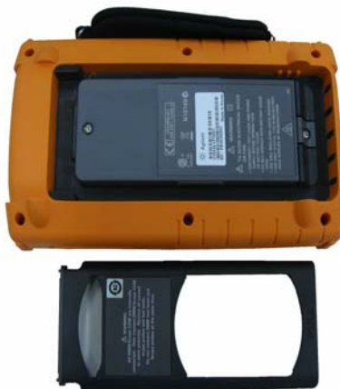
Figura 8-2 Desmonte a base do instrumento
