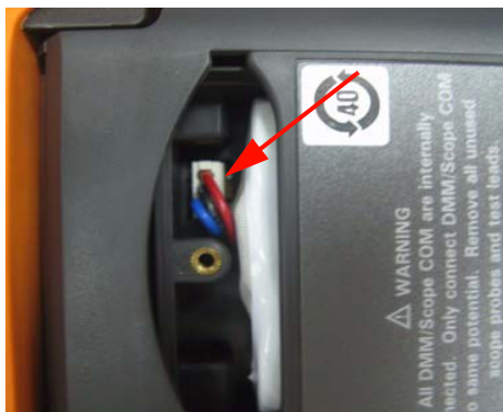
Figura 8-6 Desconecte o conector de três fios com uma pinça.
